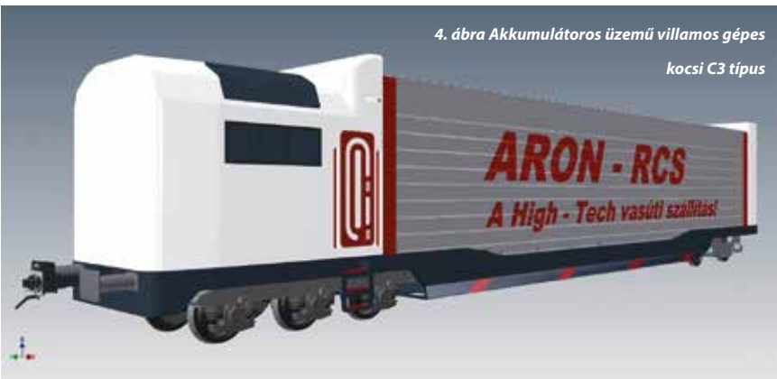
5. ábra Hajtás nélküli betétkocsi
